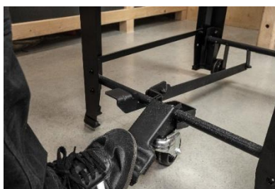
Rys. 12. Pedał w dolnym położeniu – podstawa wspiera się na kołach.
